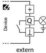
**Permanent High:** Ausgang ist dauerhaft auf +24 V geschaltet.
