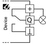
Im **passiven Modus** kann eine externe Spannung angeschlossen werden (siehe Technische Daten). Der Ausgang schaltet das angelegte Potential auf GND.
