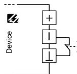
**Low-Aktiv:** Ereignis wird ausgeführt, wenn der digitale Eingang einen Flankenwechsel von high nach low erfährt.
