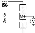
Der Skalendendwert entspricht  $I_{\Delta n, RMS}$  oder ist frei einstellbar bis  $5 \times I_{\Delta n}$ , max. 65 A. Die Übersicht zeigt, wie die Messwerte  $I_{\Delta}$  (A) von den Ausgabesignalen (in A bzw. V) proportional dargestellt werden.
